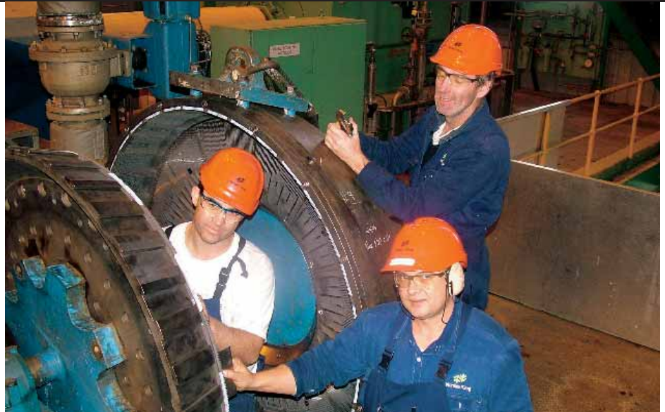
Vedlikeholdsarbeid er en vesentlig del av hverdagen på en papirfabrikk. Stu Willis (v.) John Hoogstraten og Peter Paton ved Norske Skog Tasman New Zealand, sjekker TMP-rafinøren.
