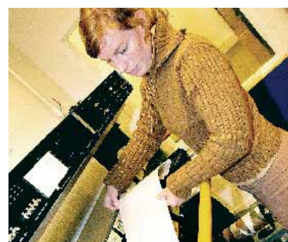
Lisa Grimstad analyserer papirkvaliteten i en av våre Tapio-analysatorer.
