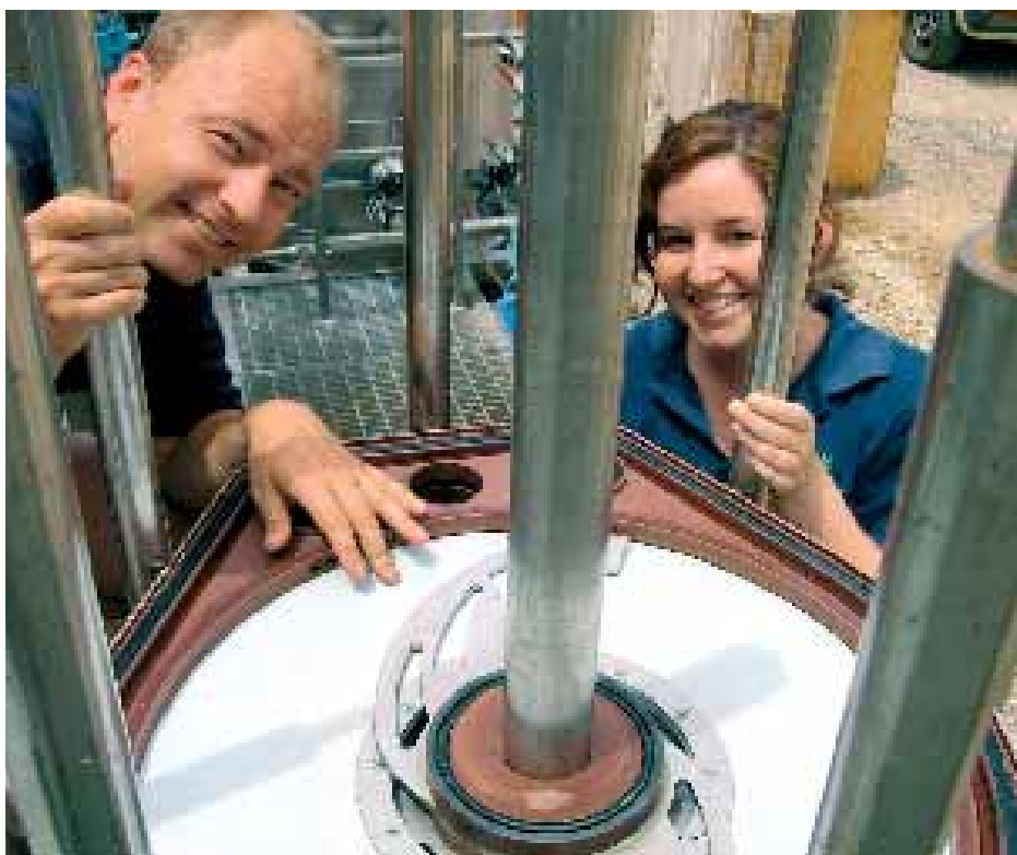
Lasse Blom og Liz Reeves inspiserer membranen på et forsøksanlegg for ultrafiltrering ved Norske Skogs fabrikk i Albury.
